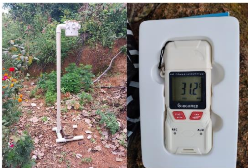
Figura: A- Mini abrigo meteorológico de PVC. Figura; B-Datalogger (medidor de temperatura e umidade)
