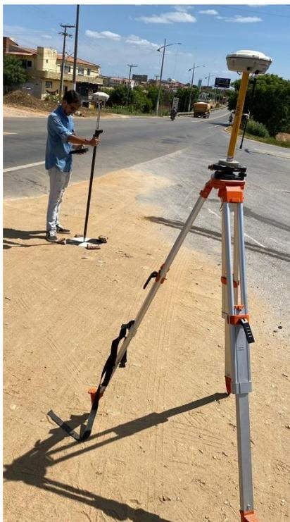
Figura 2: Coleta de pontos com GPS Geodésico
